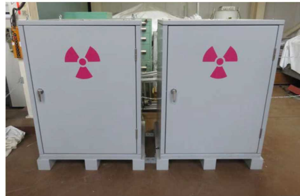
照射物管理棟の金属製の容器
