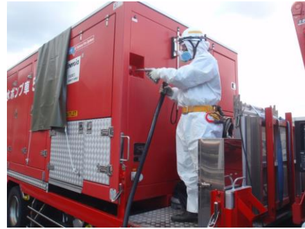
大型送水ポンプ車への給油
