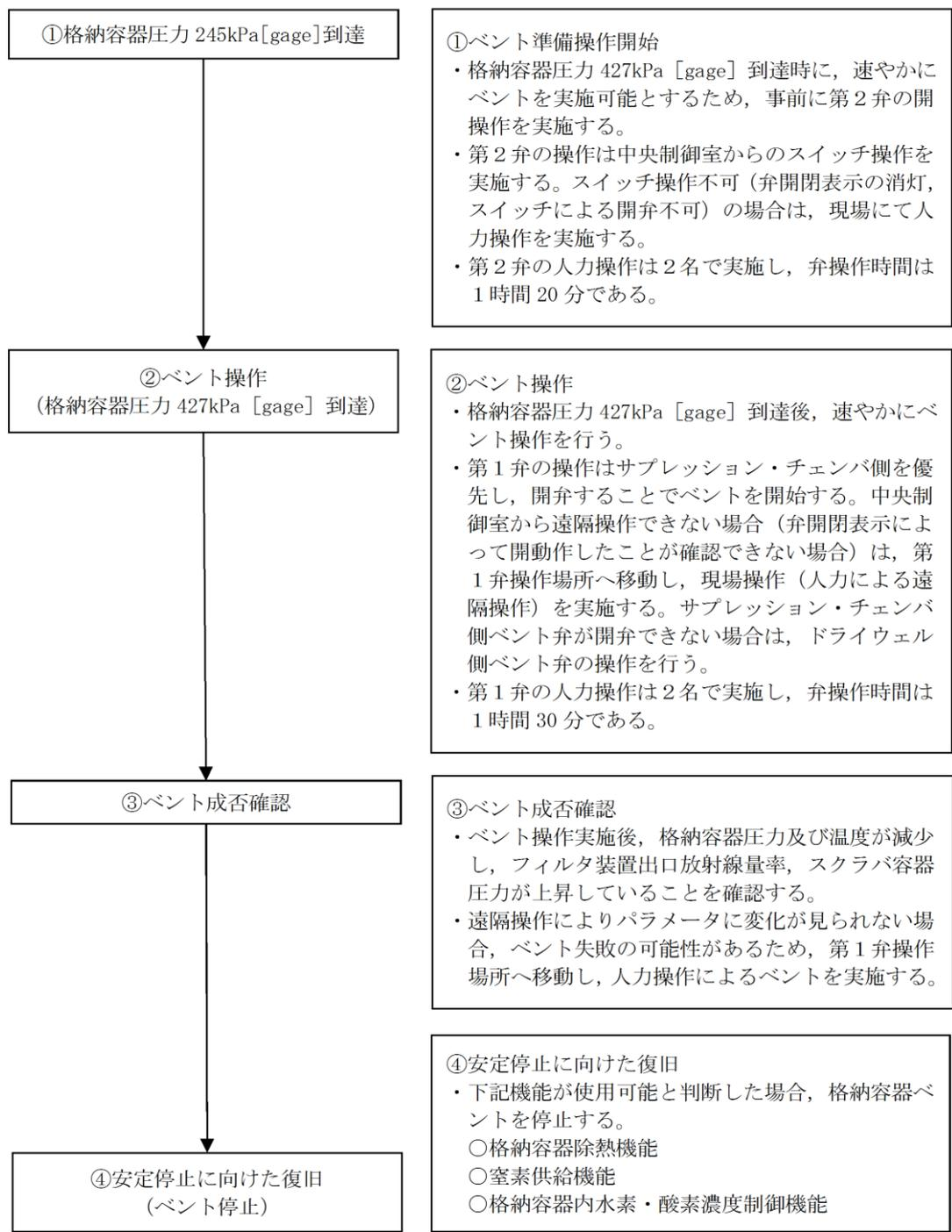
第3図 炉心損傷していない場合のベント実施フロー
