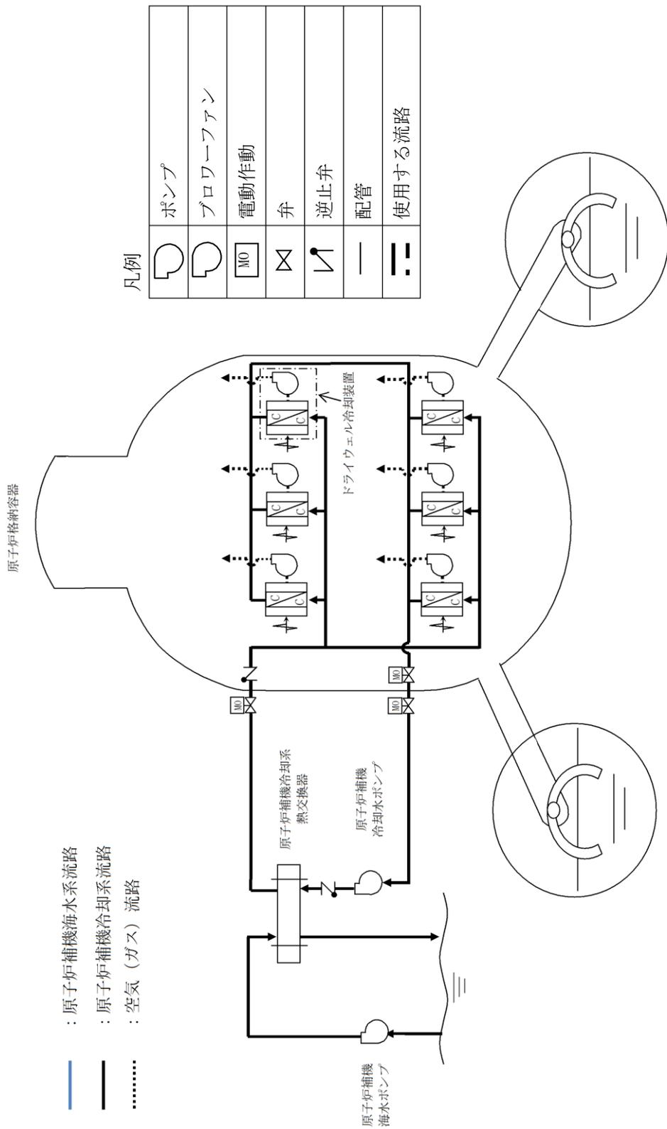
第 1.6 - 20 図 ドライウエル冷却系による原子炉格納容器内の代替除熱 (ドライウエル冷却系) 概要図
