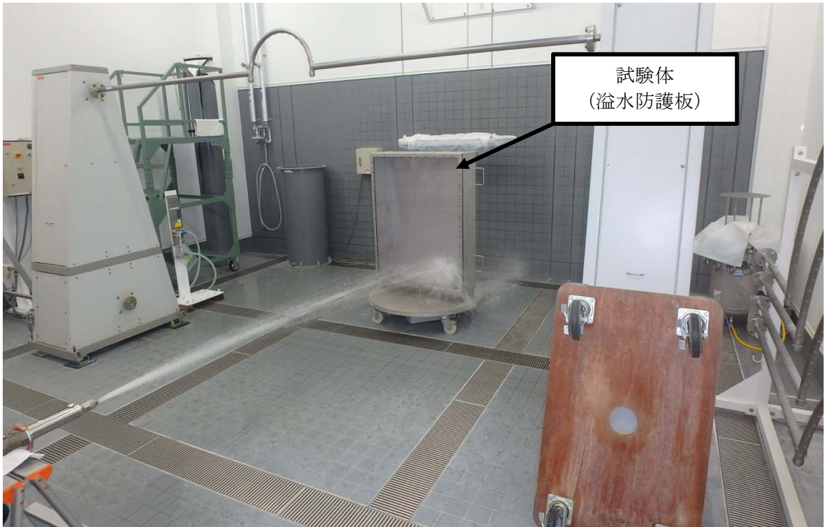
第4図 被水試験の例 (溢水防護板)
