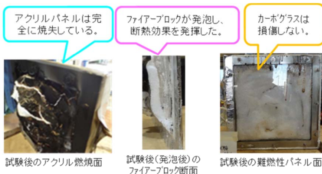
第5図 アクリルパネル燃焼後の難燃性パネルの状態
