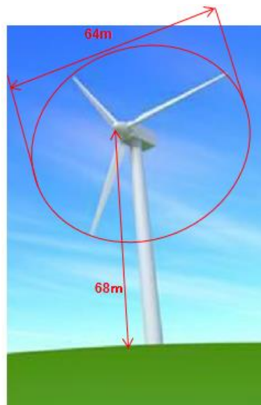
第1図 風力発電設備の寸法
