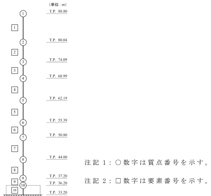
第3.5図 建屋の解析モデル図
