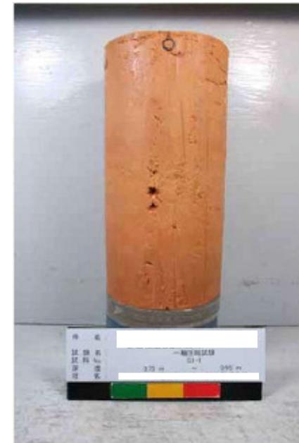
D級岩盤の供試体写真(例)
