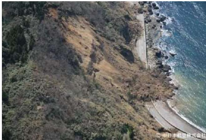
写真1:海食崖上の凝灰角礫岩層の崩壊
