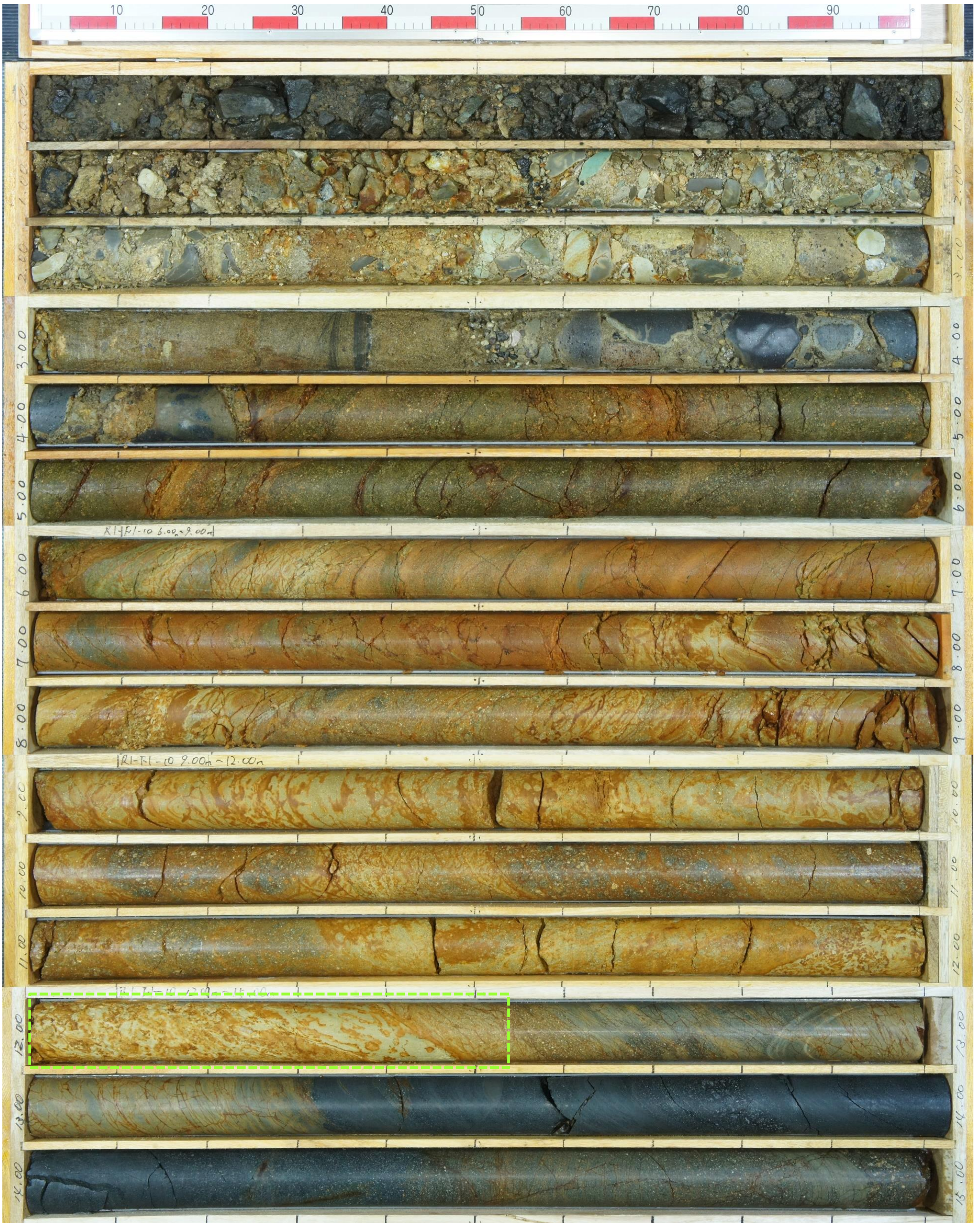
コア写真(確認-2ボーリング:深度0~15m)
