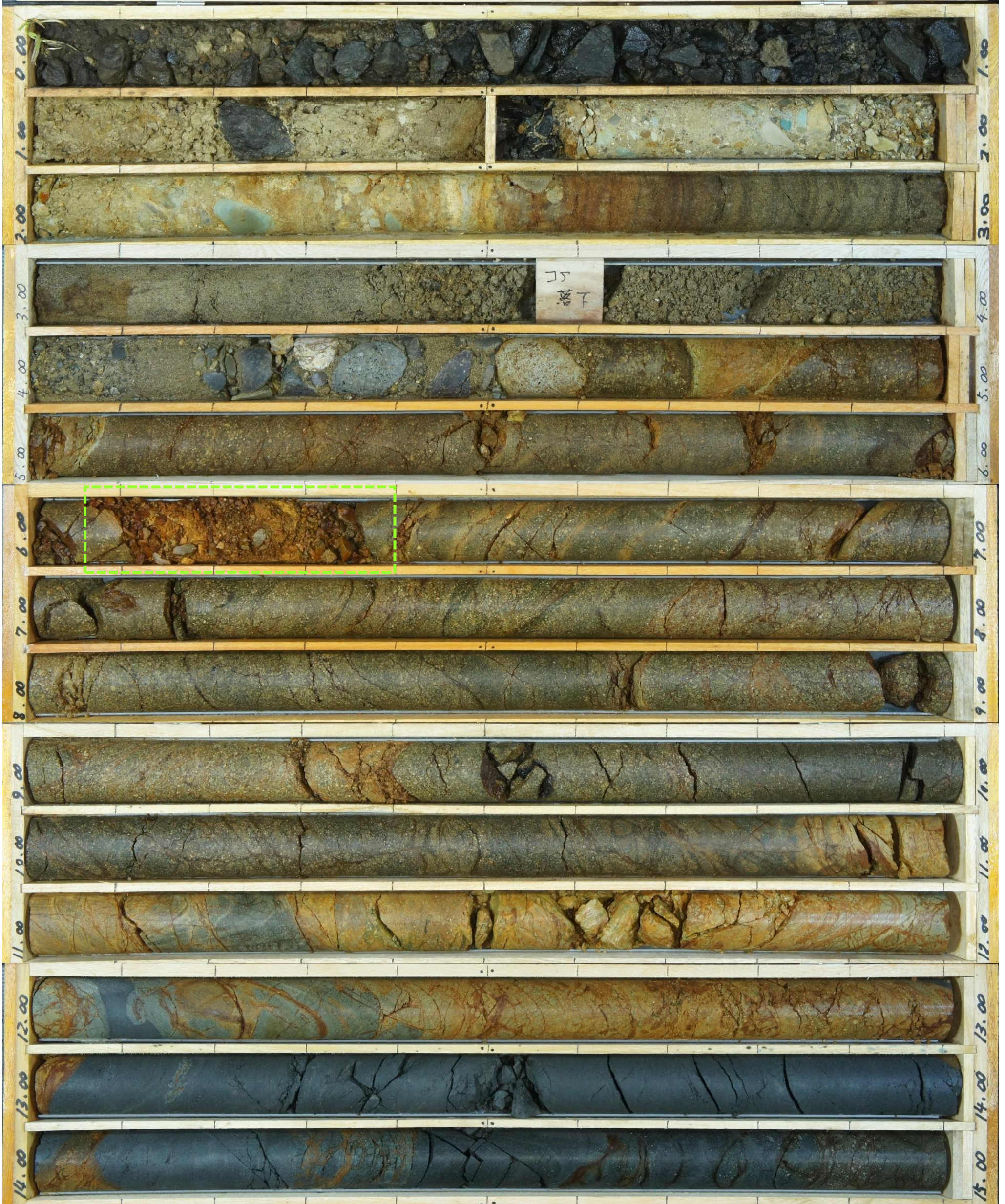
コア写真(確認-1ボーリング:深度0~15m)
