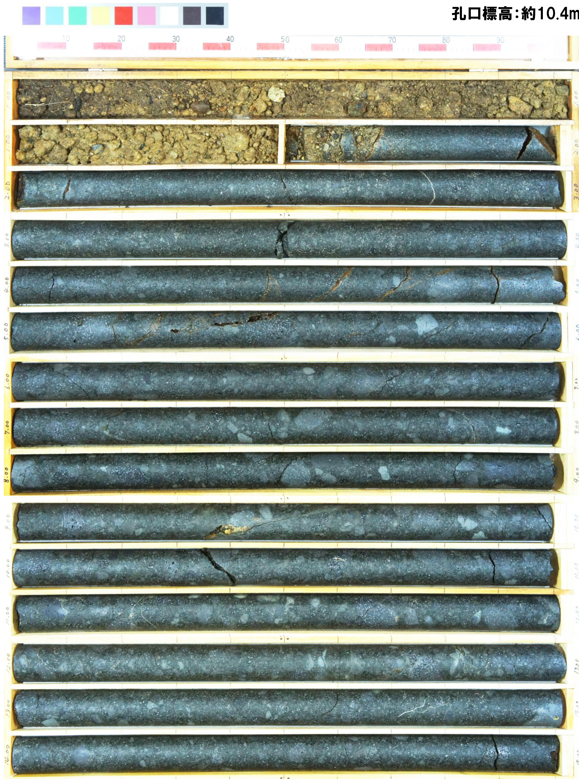
コア写真 (R1敷地-4ボーリング:深度0~15m)
