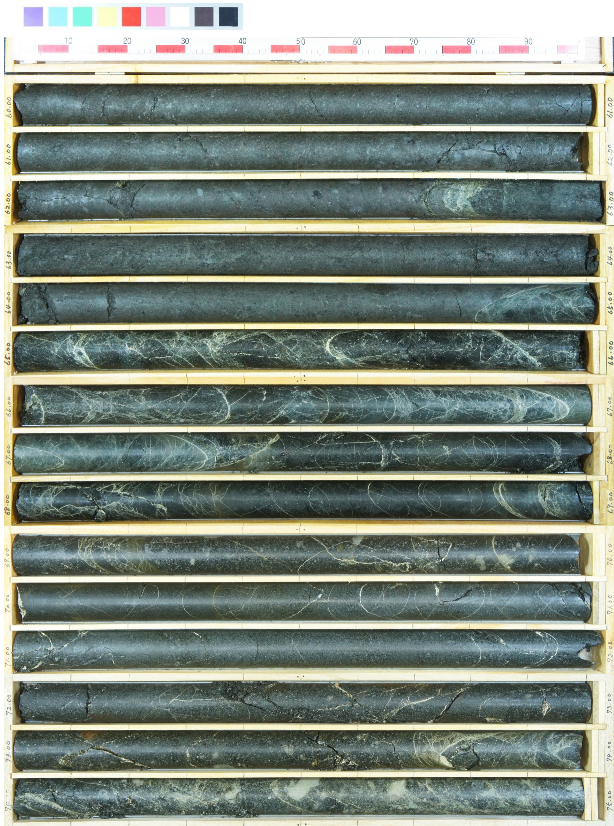
コア写真 (R1敷地-4ボーリング:深度60~75m)
