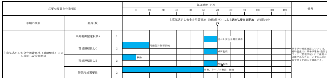
図 3.3-4 逃がし安全弁用可搬型蓄電池による逃がし安全弁(自動減圧機能付き)開放のタイムチャート*
