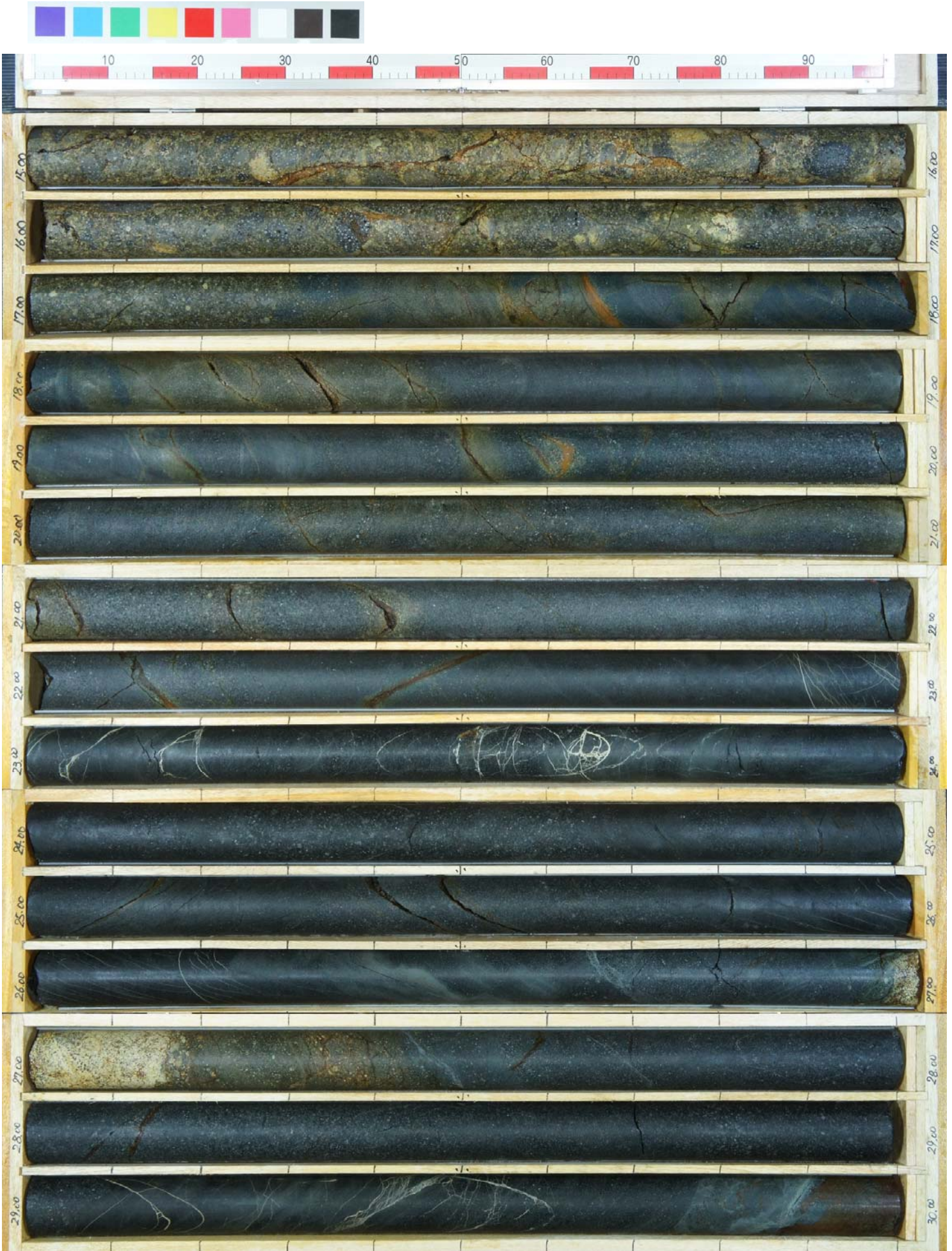
コア写真 (確認-3ボーリング:深度15~30m)
