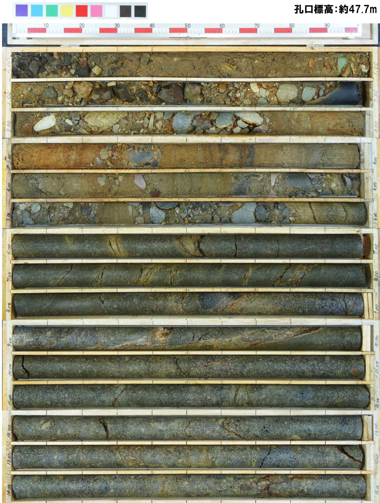
コア写真(確認-3ボーリング:深度0~15m)
