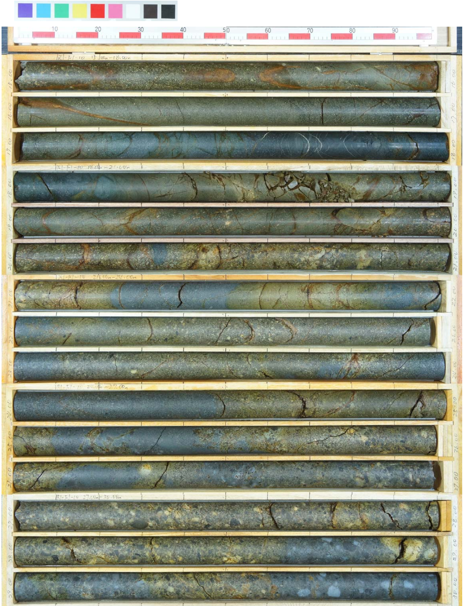
コア写真(確認-2ボーリング:深度15~30m)
