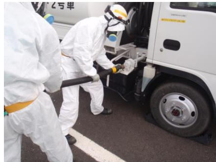
タンクローリへの燃料ホース接続
