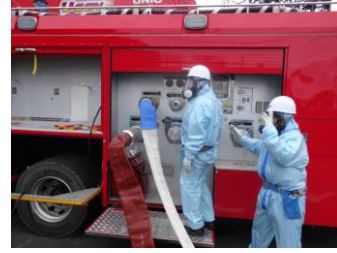
ポンプ起動操作（昼間）
