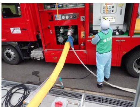
大量送水車起動
