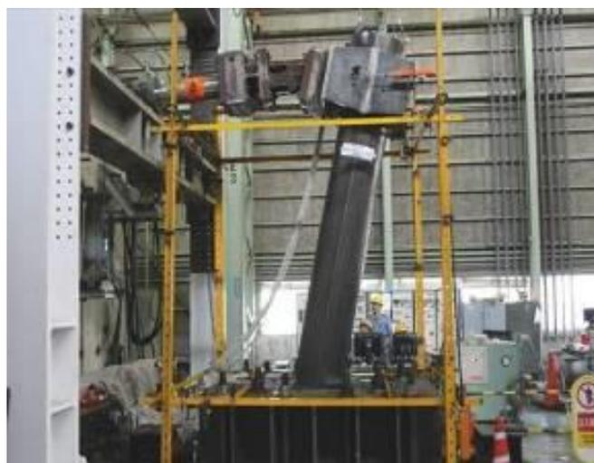
第 6 図 最大荷重時座屈状況
