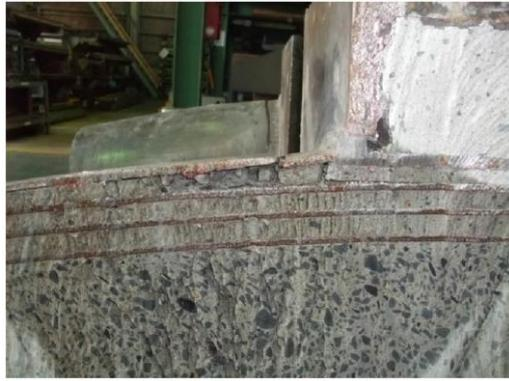
(引張線破断状況)
