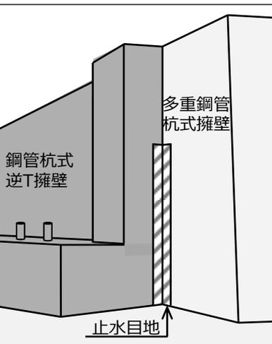
②鋼管杭式逆T擁壁 / 多重鋼管杭式擁壁 境界
