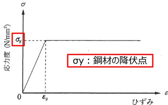
鋼材の応力度-ひずみ曲線
