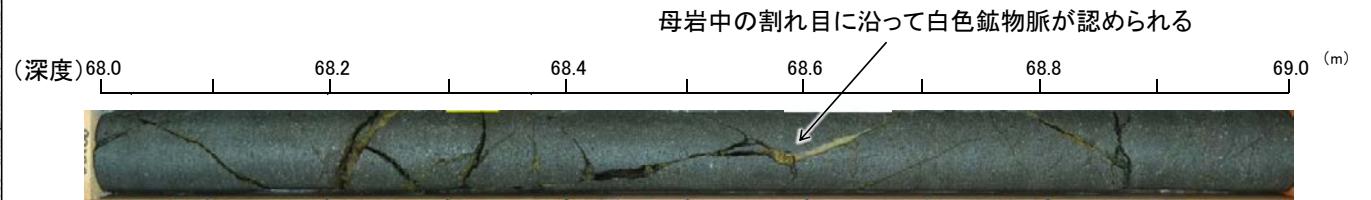
母岩中の割れ目に沿って白色鉱物脈が認められる事例 (試料 v. R-4.5孔 深度68.63m付近)
