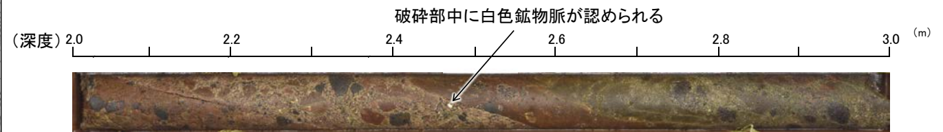
破碎部中に白色鉱物脈が認められる事例 (試料 ii. KR-13孔 深度2.47m付近)
