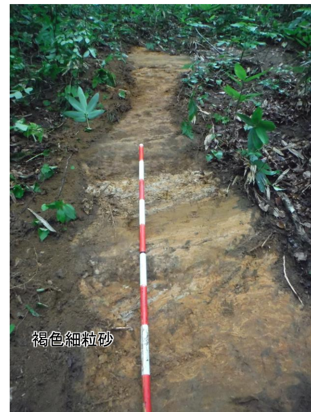
写真b 標高15~20m付近にみられる砂子又層上部層(S 3 ) ・褐色細粒砂からなり、シルト薄層を挟む。 ・葉理は25° 南東に傾斜している。
