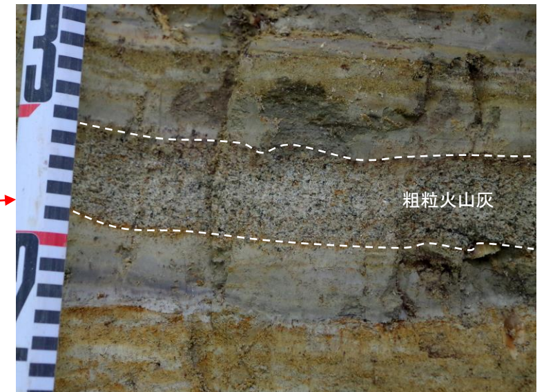
↑ Tkh露頭: 砂子又層上部層(S 3 ) (非海成層)の基底付近(標高26.5m付近)に認められる粗粒火山灰【Tkh-S_01.c.a試料】
