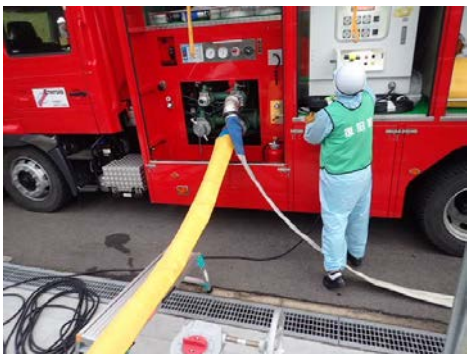
大量送水車起動
