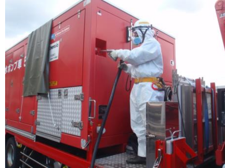
大型送水ポンプ車への給油
