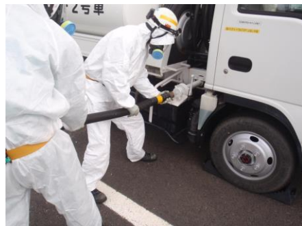
タンクローリへの燃料ホース接続
