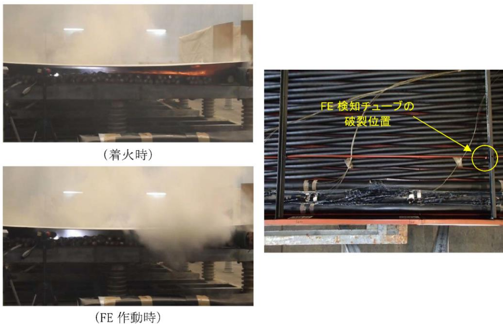
図7：試験H2における発火・消火時の状態
