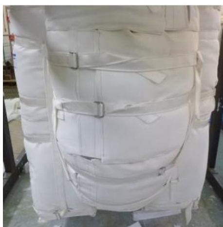
図18：耐火ラッピングの固定状況
